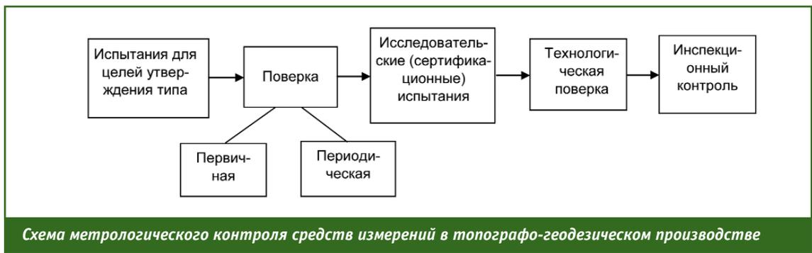
Схема метрологического контроля средств измерений в топографо-геодезическом производстве
